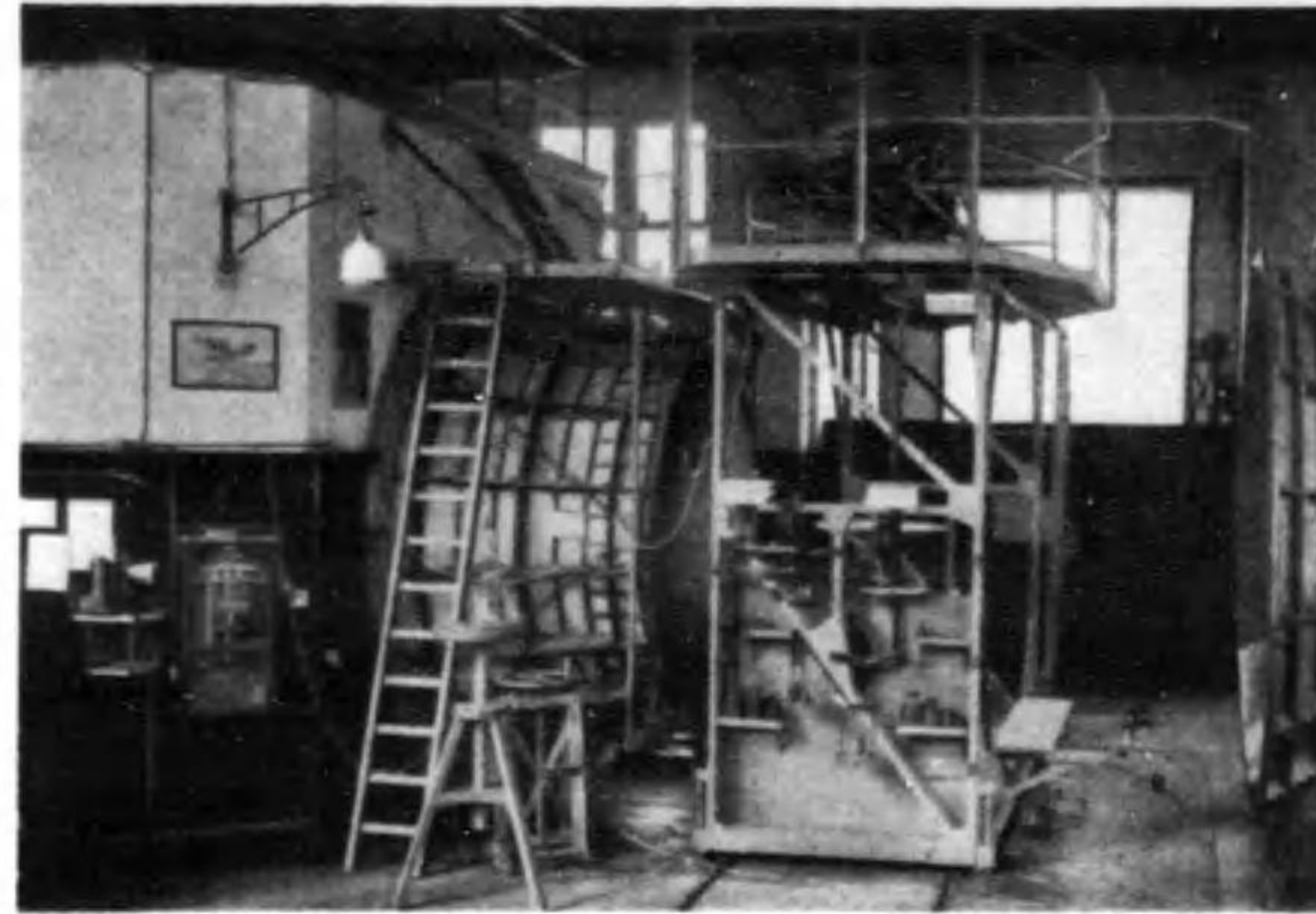
K. W. 流體研究所 (ゲッテンゲン), 航空力學實驗所の大風洞試験臺, 圖中左側に見えるのが吹出口, 右側が漏斗狀吸込口, 中央が六方向分力測定秤を備えた測定部.
