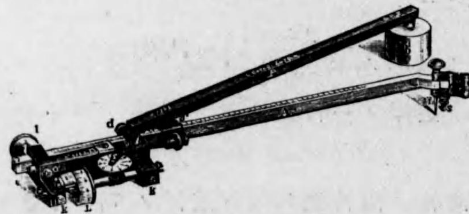
第 三 百 二 圖 補 正 測 面 器
