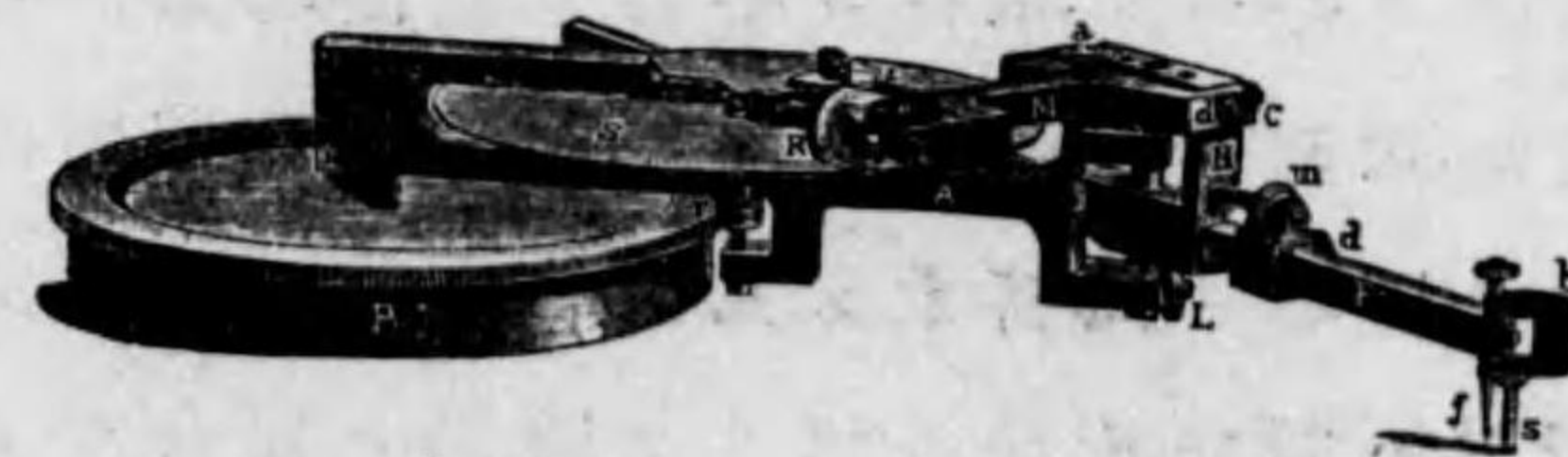
第 三 百 三 圖 吊 盤 測 面 器
