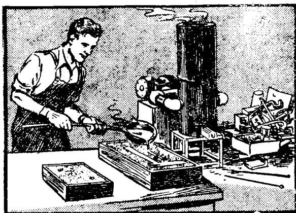
圖100. 一個人很容易管理這只小熔鐵爐。它會一次熔鐵35磅，即每小時約300磅。
