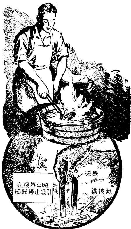
圖103. (上)把鋼鐵加熱到鮮紅色,而後浸入水中,可增加鋼鐵的硬度與耐用性。(下)鋼被熱到臨界點時,磁鐵不能吸引它。
