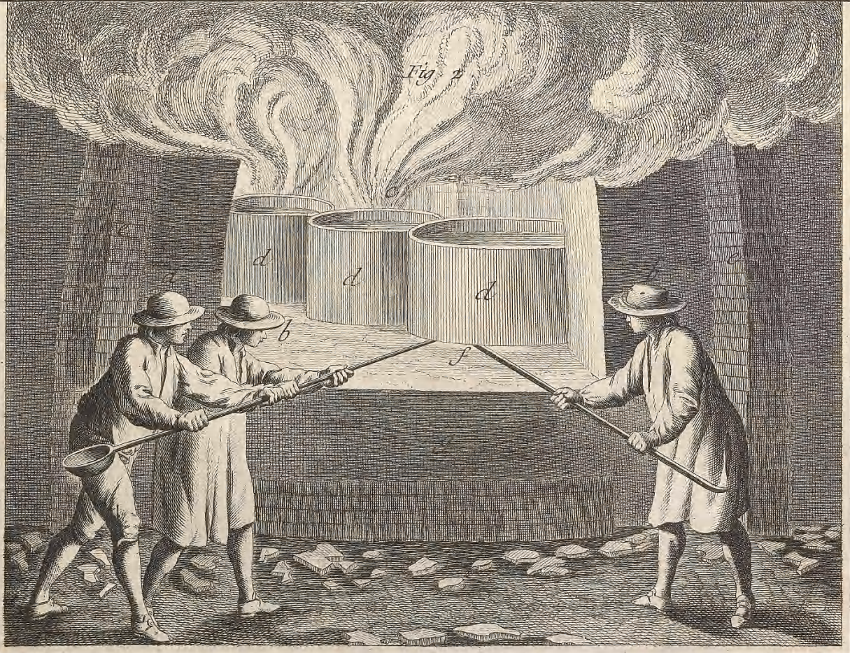
Verrerie en bois, l'opération de racommoder le Banc et de relever les Pots.
