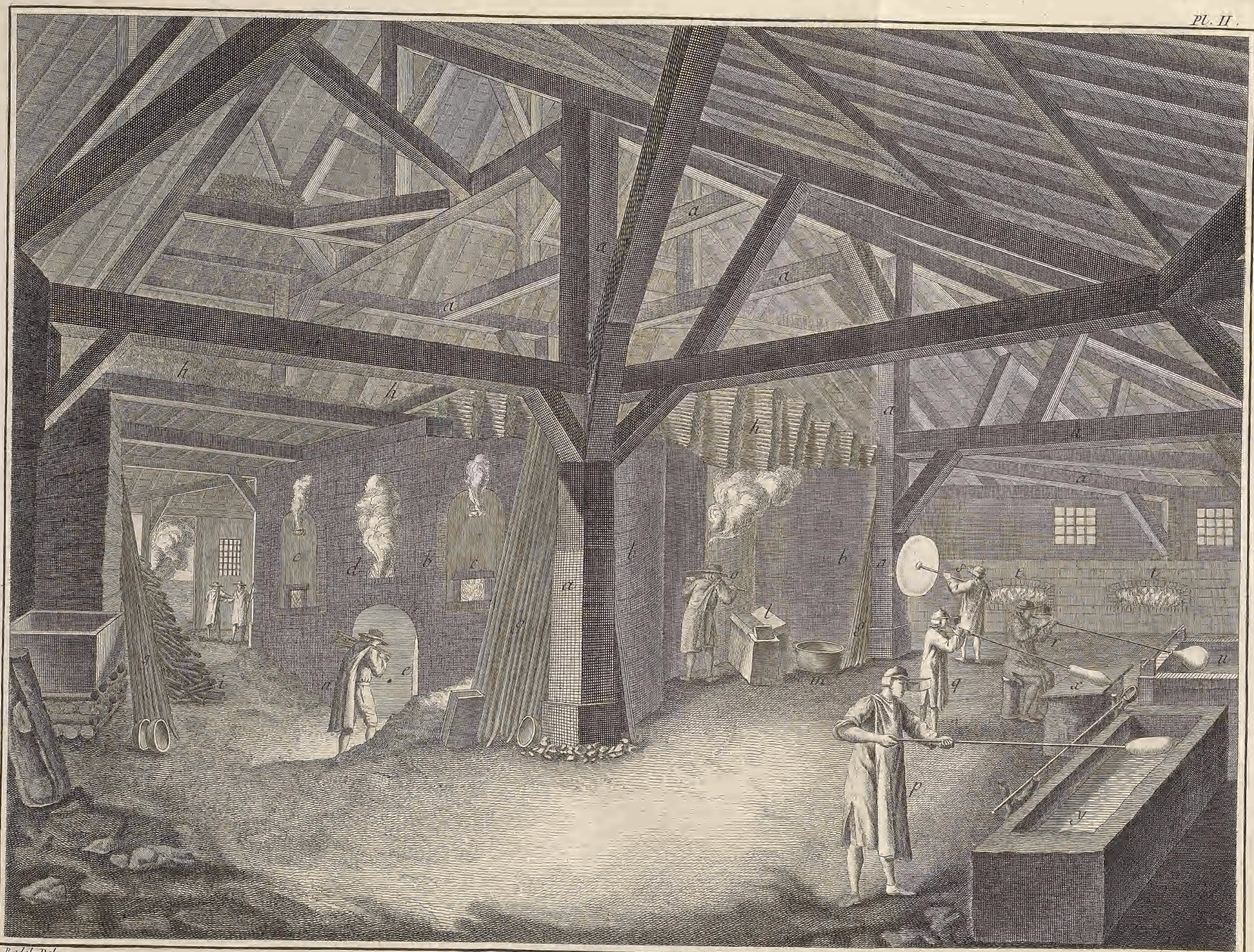
Verrerie en bois, Grande Verrerie en Plats. Intérieur d'une Halle et différentes Opérations de la Verrerie à Vitres.
