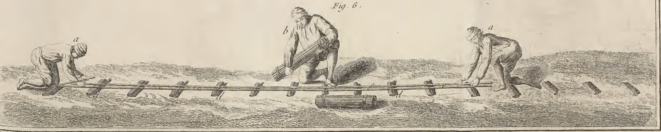
Verrerie en bois, Différentes Opérations pour filer les Tubes des Barometres, pour les couper &c. &c.
