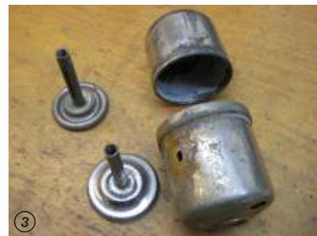
Im behandelten Fall wurden alle Teile sorgfältig gereinigt, neue Dichtungen und die Filzeinlage geschnitten, der fehlende Verschluss für den Wassertank gedreht, die gebohrten Löcher verschlossen und das Zentralrohr im Wassertank neu verlötet.
