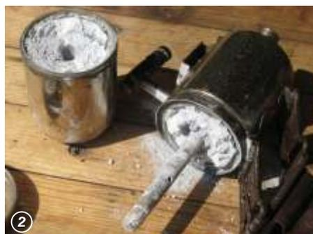
scheibe, ähnlich einer U-Scheibe, überdeckt und dicht verlötet. Nun gilt es, durch die Löcher hindurch zu wässern und mit einem harten Draht oder einem Bohrer den Inhalt zu zermürben und die Mittelachse freizuarbeiten. Geduld ist angesagt. Essig kann auch helfen.
