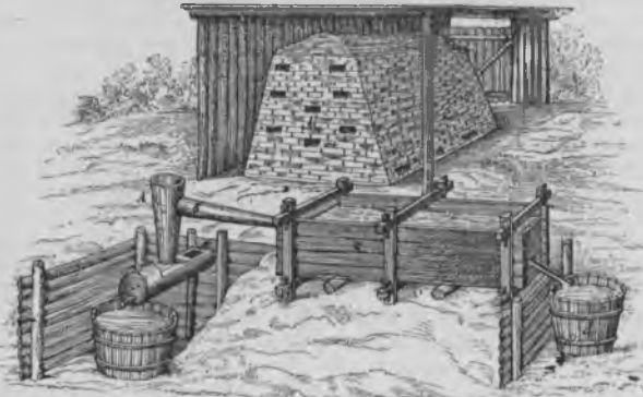
5. Печное смолокурение въ вологодской губ.; внизу—приспособление для улавливанія скипидара.
