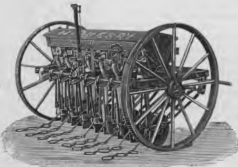
6. Машина Макъ-Шерри: справа — часть удобрительнаго ящика съ дискомъ и лапами.
