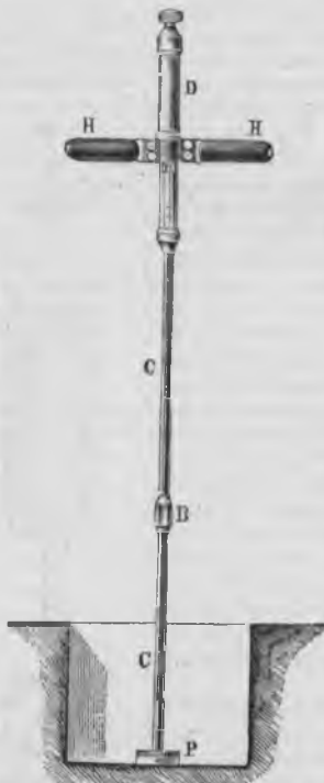
7. Приборъ Майера; слева—общій видъ, съ деталями; справа—во время испытанія грунта.
