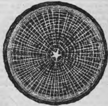
5. Поперечный разрѣзъ ствола дуба; въ центрѣ звѣздообразная сердцевина, отъ нея расходятся сердцевинные лучи.
