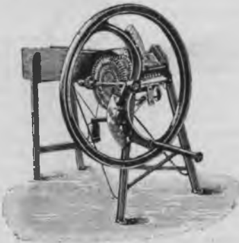
7. Передача помощью сложной конической шестерни въ соломорѣзкѣ Морица.
