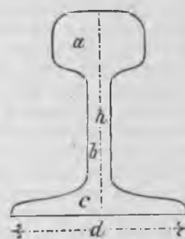
1. Поперечный разрѣзъ виньольевскаго рельса: а—головка, b—шейка, с—пята; d—ширина пяты; h—высота поперечнаго сѣченія.
