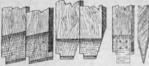
8. Острія шпунтовыхъ свай; справа—фасадъ и разрѣзъ шпунтовой свай съ башмакомъ.
