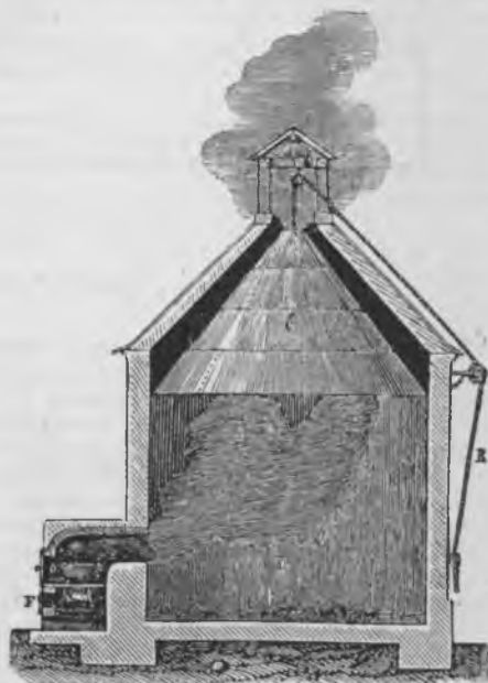
1. Простая сажекопильня; F —очагъ, O —сосудъ со смолою, D —копильная камера, C —колпакъ для сажи, R —веревка съ блоками для подниманія и опусканія колпака.
