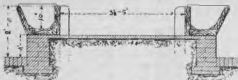
17. Установка корытъ на кормовомъ проходѣ.
