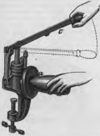
17. Гидравлическая капсюльная машина: а—отверстіе для горлышка бутылки, выложенное каучукомъ; б—цилиндръ съ водою или съ глицериномъ; с—рукоятка.
