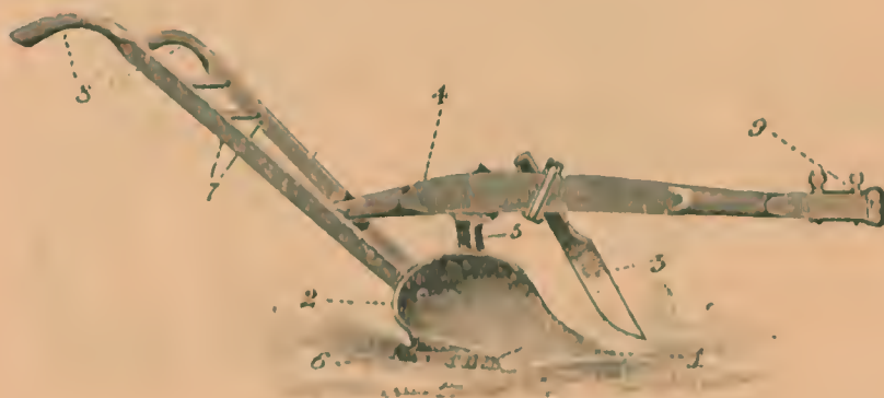
Arado Sulky. 1, relha ou bleo; 2, Aiveca; 3, facão ou segão; 4, Tuião ou apo; 5, Telrós; 6, Rastro ou ceppo; 7, Rabieças ou braçadeiras; 8, punhos; 9, Regulador.
