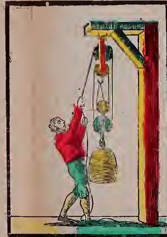
De Takel werkt beknopt en goed, Dees Man weet wat 't karrolwerk doet. Hij trekt den Last op langs veel schoven, Op welk, de touwen wel iets wriven Maar daar hij weinigt acht op 't al Offehoon zyn werk heel iszaam gaat.
