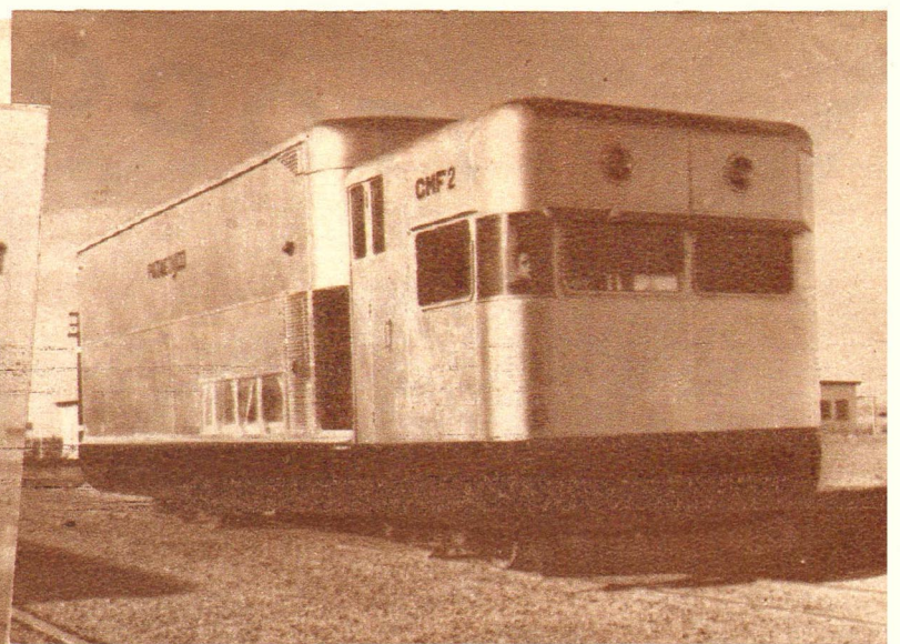
Coche frigorífico del F. C. Patagónico, equipado con el motor de un ómnibus en desuso.
