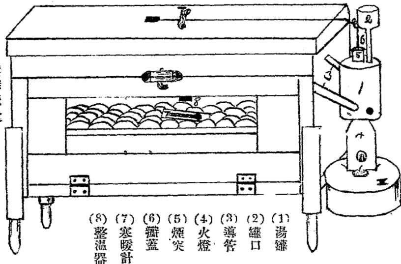
上圖由漏斗形之罐口注入熱湯經湯罐及導管而入內部之湯槽湯罐下部有火燈以暖罐內之水湯罐上部有煙突接於煙突上部有瓣蓋若孵卵器內溫度過高由整溫器之作用將瓣蓋吊於上方火燈之熱力得由煙突逸出湯之溫度因之下降器內置寒暖計以測溫度之高低不使過與不及也
