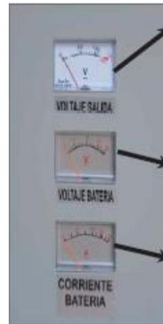
Voltaje de salida del equipo: Registra el voltaje de salida sea cual sea el modo de operación del equipo siempre que el Breaker de salida del equipo se encuentre en la posición de encendido (ON).
