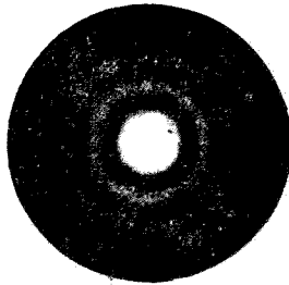
圖 38.——圓形徑口所生繞射像型之照相
