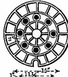
FIG. 7. BROOKLYN, (N. Y.) MANHOLE COVER, 1896. AVE. WEIGHT, HEAD, 395 LBS. " " " COVER, 130 "
