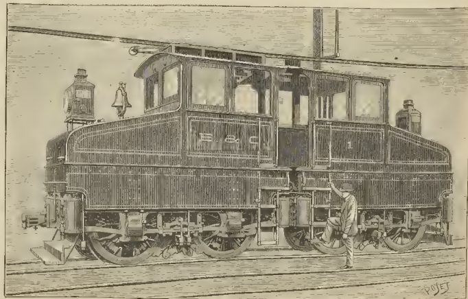
Fig. 3. - Vista en conjunto de la locomotora eléctrica de 96 toneladas construida por la General Electric Company para la compañía del ferrocarril de Baltimore á Ohio
