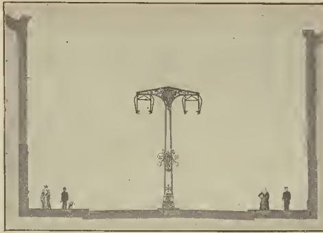
Fig. 6. - Perfil de un soporte con dos sostenes
