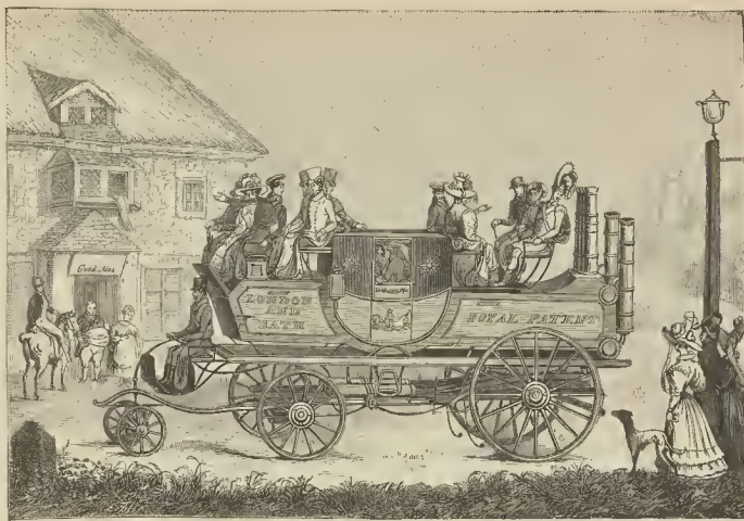
Fig. 3.—Coche de vapor de Garney, probado en Londres en 1827 (copia de un grabado inglés)
