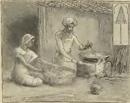
Fig. 4. — Cochura de los capullos. En el cartucho cono de bambú para quitar la borra á los capullos
