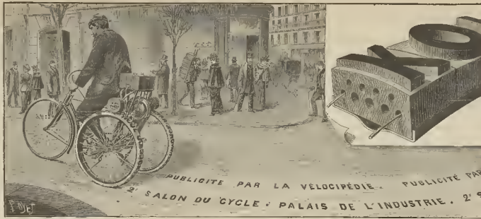
Fig. 2. Triciclo impresor de anuncios. - A la derecha detalle de las ruedas traseras
