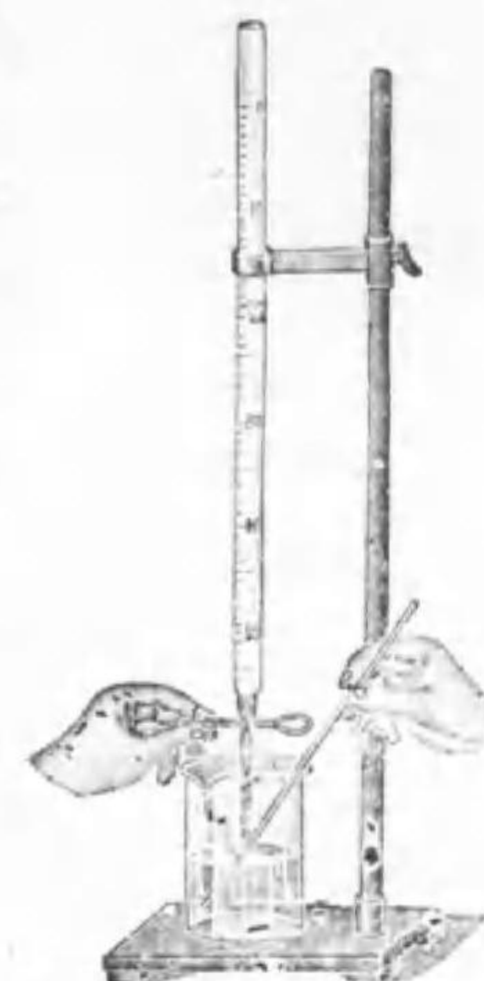
第90圖 容量分析を行ふ標準溶液をビュレットから滴加してビーカー中の溶液の濃度を定める
