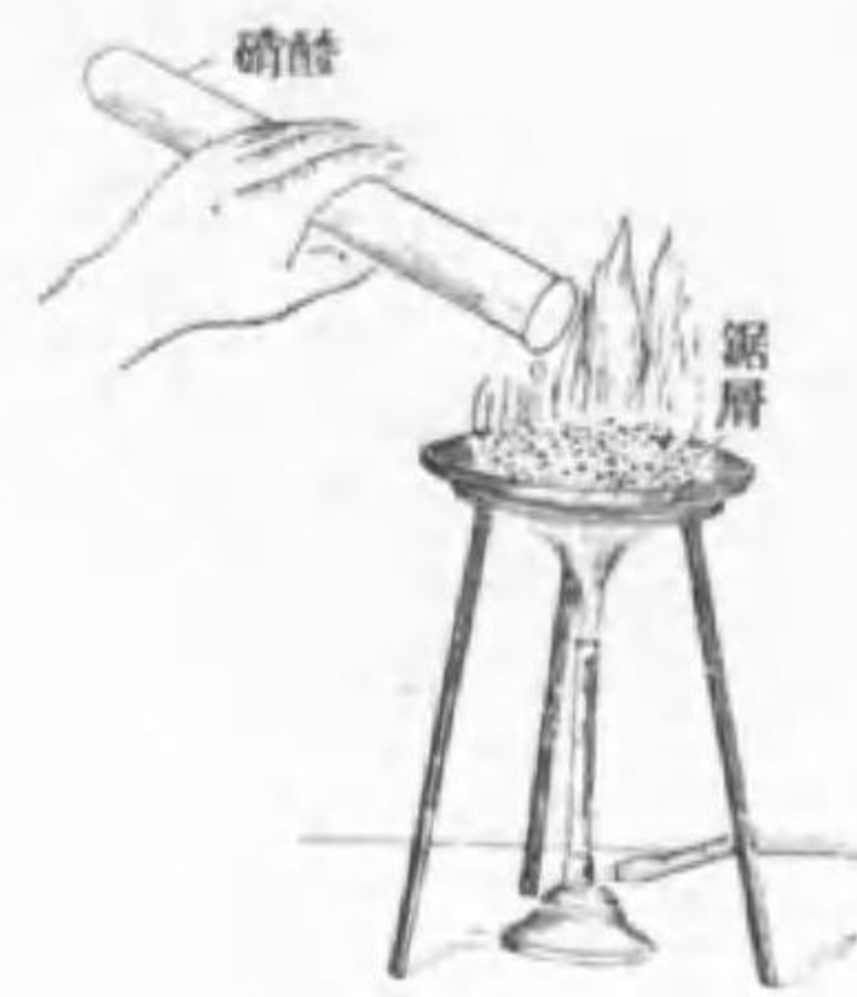
第 69 圖 硝酸が銅屑を酸化して 燃焼させることを示す
