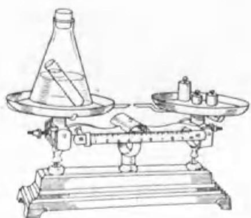
第 43 圖 質量不變の定律を示す實驗
