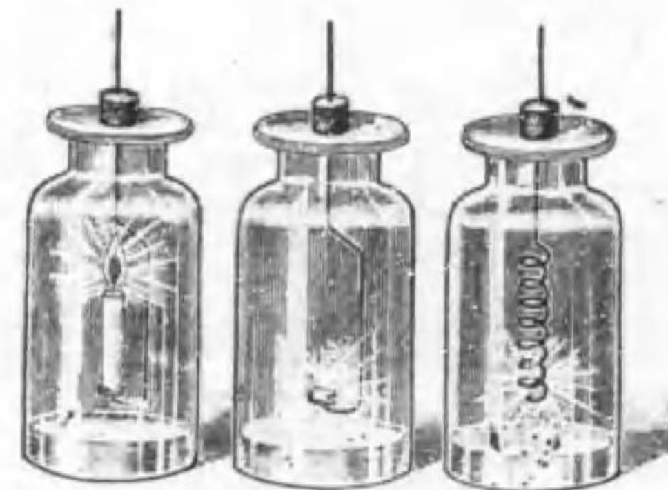
(1) (2) (3) 第5圖 酸素中で(1)蠟燭、(2)燐、(3)鐵線などの燃焼する有様
