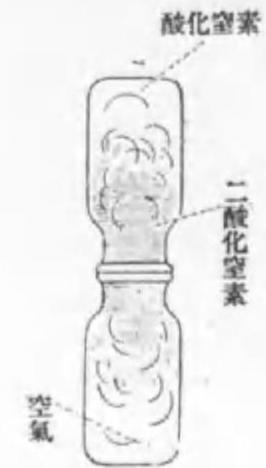
第 72 圖 酸化窒素と空氣とを混ぜると二酸化窒素を生ずる
