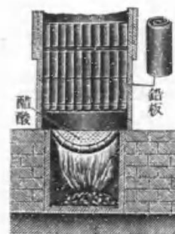
第111圖 鉛白の工業的製法 稀薄な醋酸を入れた器の上に巻いた鉛板を置き、器を炭火で温めると、鉛の表面は次第に鉛白となる
