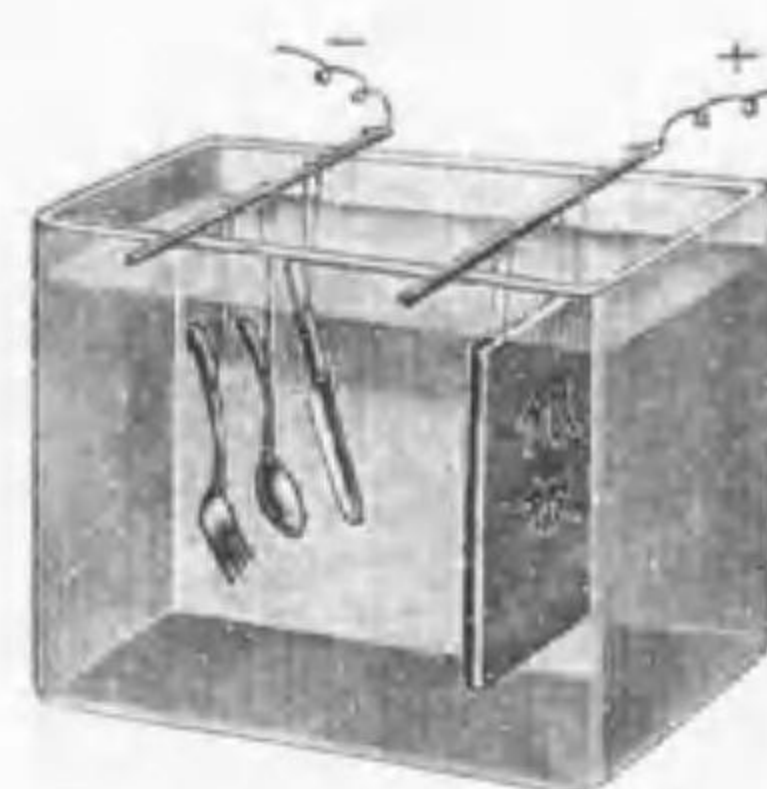
第103圖 鍍銀法 陽極に銀板を吊るし陰極に鍍銀する物體を吊るす
