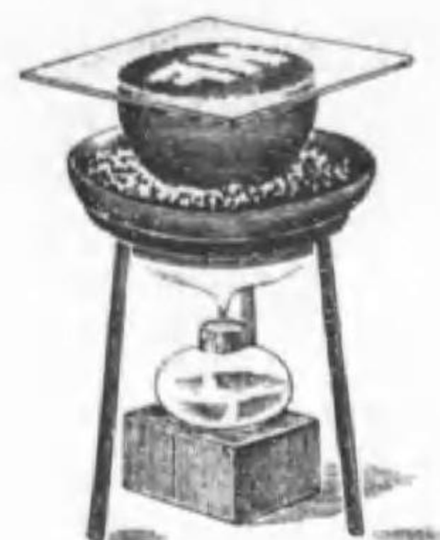
第 61 圖 弗化水素の製法 及びその作用
