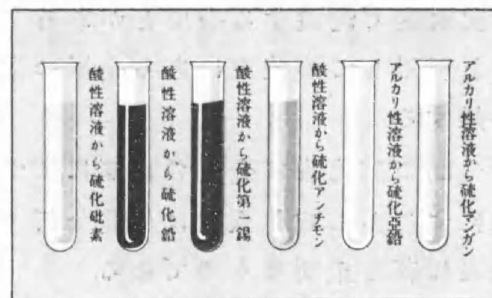
第 87 圖 金屬硫化物の沈澱
