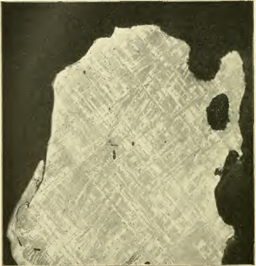
Fig. 2. Widmanstättensche Ätzfiguren auf der Schnittfläche des abgebildeten Meteoreisenblocks. ( \frac{5}{8} n. Gr.)
