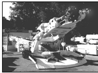
Прохідницький комбайн П110 Новокраматорського машинобудівного заводу.
