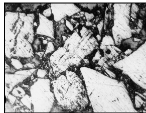
Фрагмент вуглемасляного агломерату, \times 125 : білі зерна — вугільні частинки; темна речовина — масляновугільна суміш.
