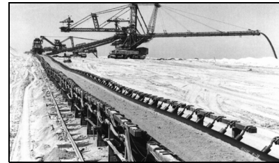
Стрічковий конвеєр з відвалоутворювачем на кар'єрі.
