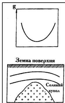
Рис. Схема гравіметричної розвідки. Мінімум прискорення сил тяжіння (g) над солоним куполом.
