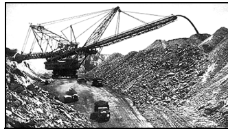
Роторний екскаватор на вугільному кар’єрі (США).
