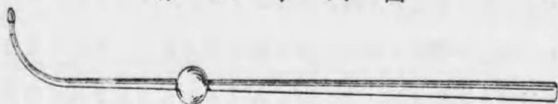
火吹管 Blow Pipe (第66圖) 眞鍮製ノ管デ普通ノ「アルコールラム」 第 六 十 六 圖
