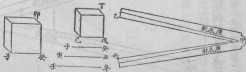
之四線。取其第二線度。置於尺之甲乙線上。又按甲乙線所截各度。移置甲丙線。即成比例尺之分體線也。以用法明之。如有一坎庚正方體。欲作大二倍之體。則將比例尺展開。使其庚與庚第一次所截之點。相距之度。與艮庚界度等。次取比例尺乾與乾第三次所截之點。相距之度。即是比坎庚正方體大二倍之正。
