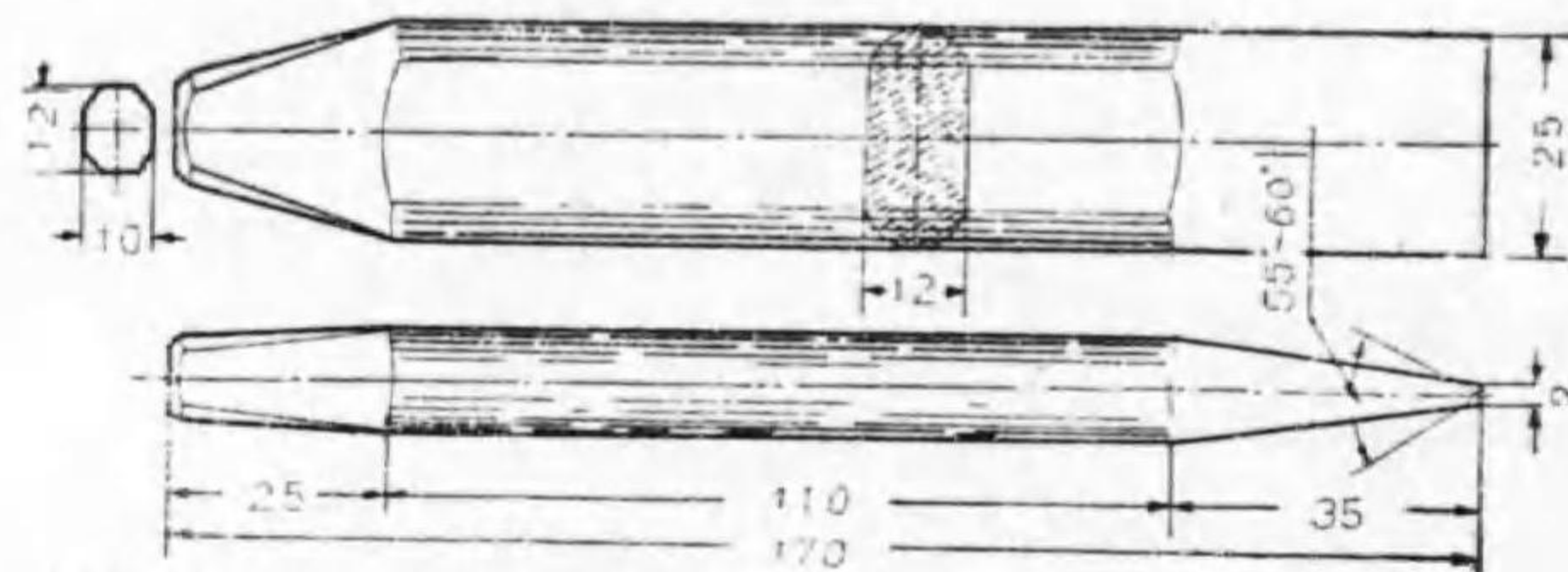
第488圖 平鑿製作の寸法
