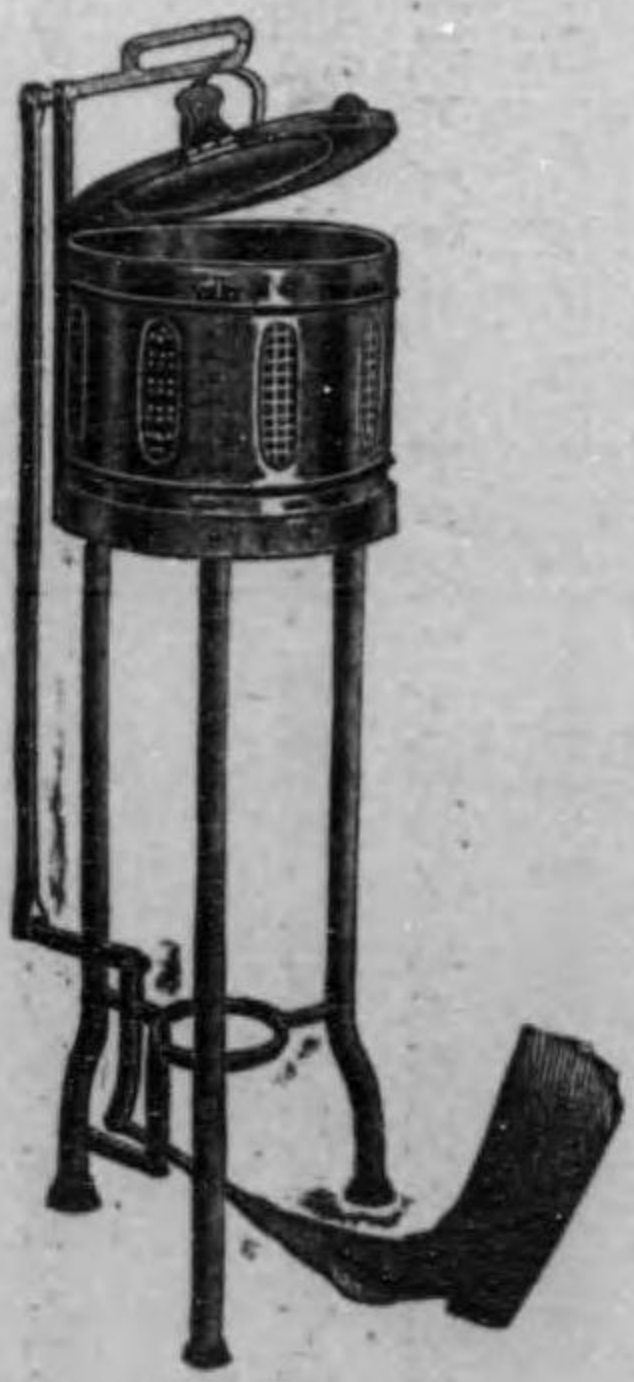
圖八十三百三第 ビ及槽貯品帶繙 置裝閉開壓足其
