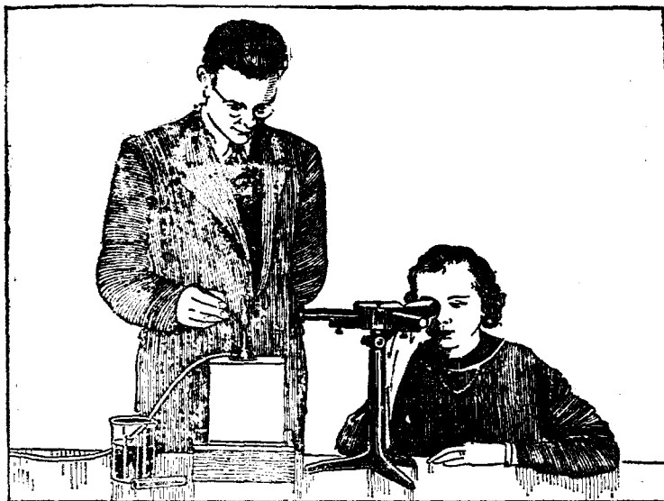
圖 197 A 用以研究火焰的本生分光鏡
