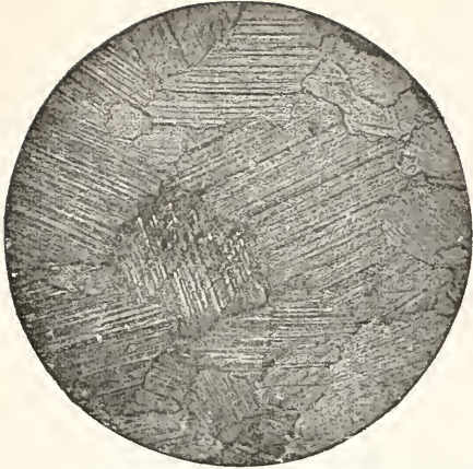
Fig. 6. Zwillinglamellen im Dünnschliff eines plastisch deformierten Marmorkörpers. Nach Versuchen des Verfassers.
