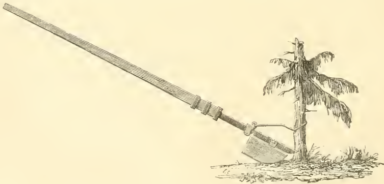
Fig. 20. — Position du levier Ménard au début de l'arrachage.
