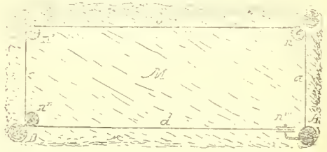
Fig. 8. — Installation d'un fil avertisseur d'incendie dans une meule.
