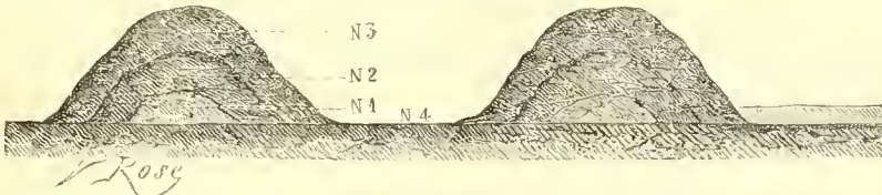
Fig. 159. — Coupe verticale des fours, après la combustion.
