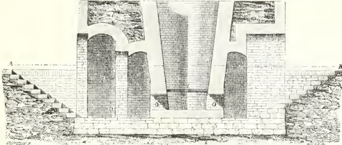
Fig. 107. — Coupe longitudinale d'un four à chaux (suivant A-B de la figure 105).
