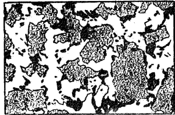
圖65 一片磨光的花岡石面，顯示是長石(灰色)、雲母(黑色)，和石英(白色)三種晶體所成。
