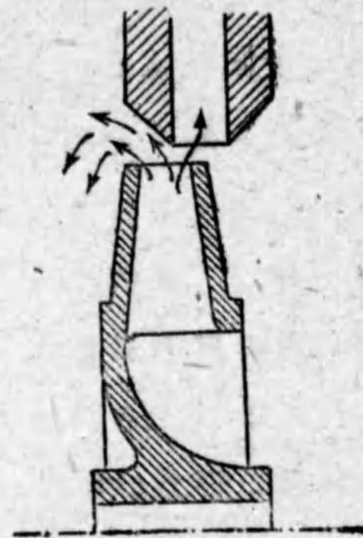
第 157 圖 軸推力を軽減する一方法
