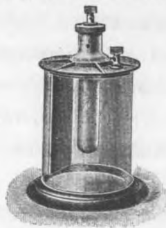
圖 33. 溫勒爾氏以鑿有細孔之管，繞於鉛製陽極之斷續器(Schall)
