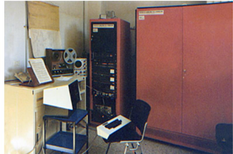
Vista d'insieme del TAU2: a sinistra il posto di lavoro utente, il rack dell'Unità Digitale, con gli apparati di mixaggio e amplificazione e a destra l'Unità Audio.
