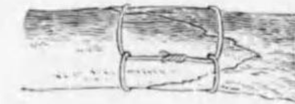
第二百九十一圖 鋸接合法
