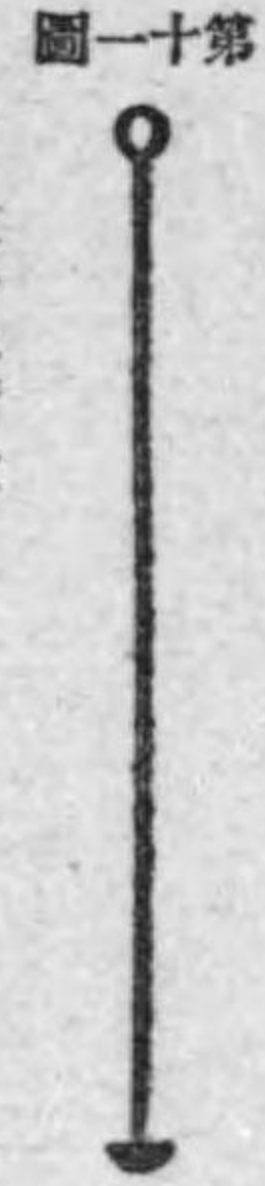
圖一十第 もので、熔室内に敷く骨灰の掻きならし又は火床の灰落しなどに用ゐられる。
