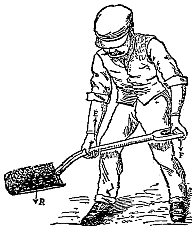
圖 16 鐵鏟爲重量近於一端之槓桿，在他端之手作用如支點。
