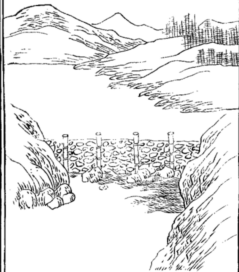
石籠切董又謂之卧半判竹或用藤蘿或木條編作圈眼大籠長可三丈高約五尺以鐵樁止之就置田頭內貯塊石用掌裹水或相接連延遠至百步若水勢稍高則壘作重籠亦可遏止如遇隈岸盤曲尤宜周折以禦奔浪併作洄流不致衝蕩埂岸農家瀕溪護田多習此法比於起疊堤障甚省工力又有石笆辦水與此相類詩云誰偏藤竹作長籠牆紅塊石填來勢自雄蠍切計蠍切孔有形橫巨浸鯢鯢無力戰秋風波濤已捲奪騰勢壠畝都歸扞禦功擬喚六丁鞭爾去若爲能障百川東
