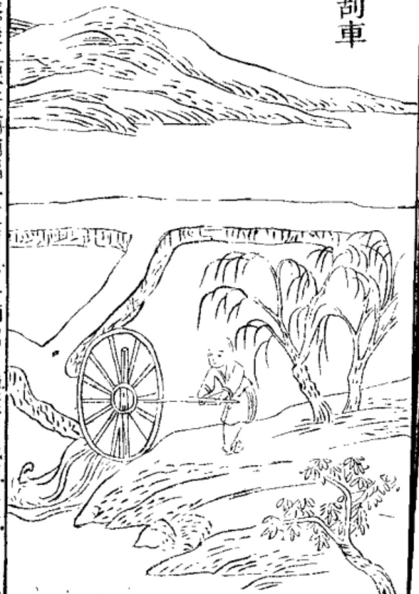
輻同潤然後立架安輪輻半在槽內其輪軸一端環以鐵鉤木拐一夫執而掉之車輪隨轉則衆輻循槽刮水上岸溉田便於車廬詩云創物須憑智巧先泝流能使
