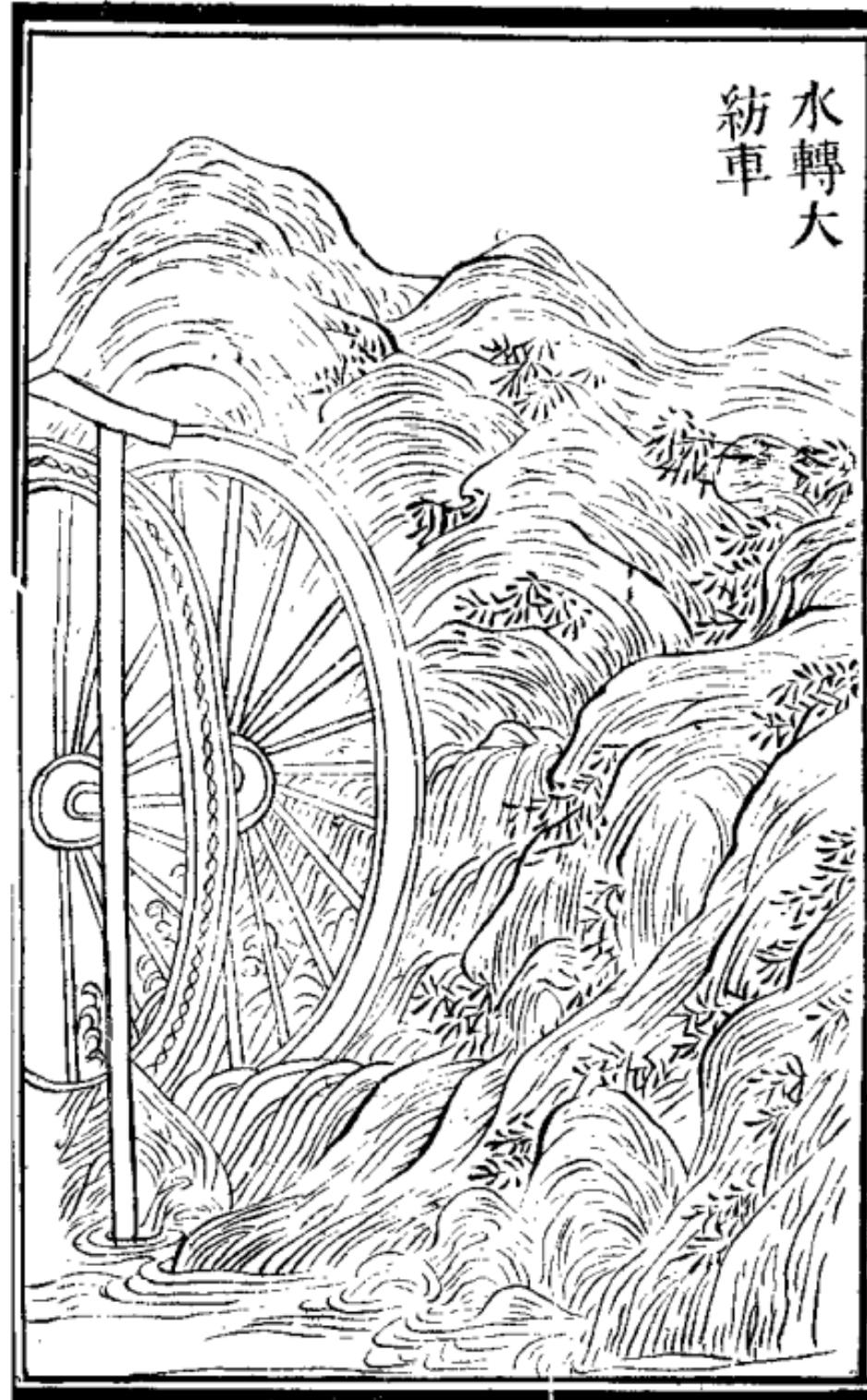
水轉大紡車此車之制見蘇苧門萃不具述但加所轉轂水輪與水轉輶磨之法俱同中原蘇苧之鄉凡臨流處所多置之今特圖寫庶他方績紡之家倣此機械比用陸車愈便且省庶同獲其利詩云車紡工多日百劖更憑水力捷如神世間蘇苧鄉中地好就臨流置此輪
