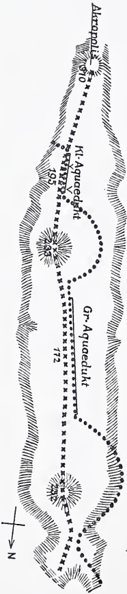
Die griechische Druckwasserleitung (xxx) und eine römische Wasserleitung (····) in Pergamon.
