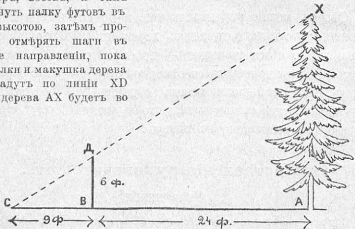
столько разъ больше высоты палки, во сколько разъ все разстояніе отъ А до С больше разстоянія отъ В до С, иначе говоря, если все разстояніе АС—33 фута, а разстояніе ВС 9 футовъ (при высотѣ палки 6 ф.), то высота дерева будетъ 22 фута.
