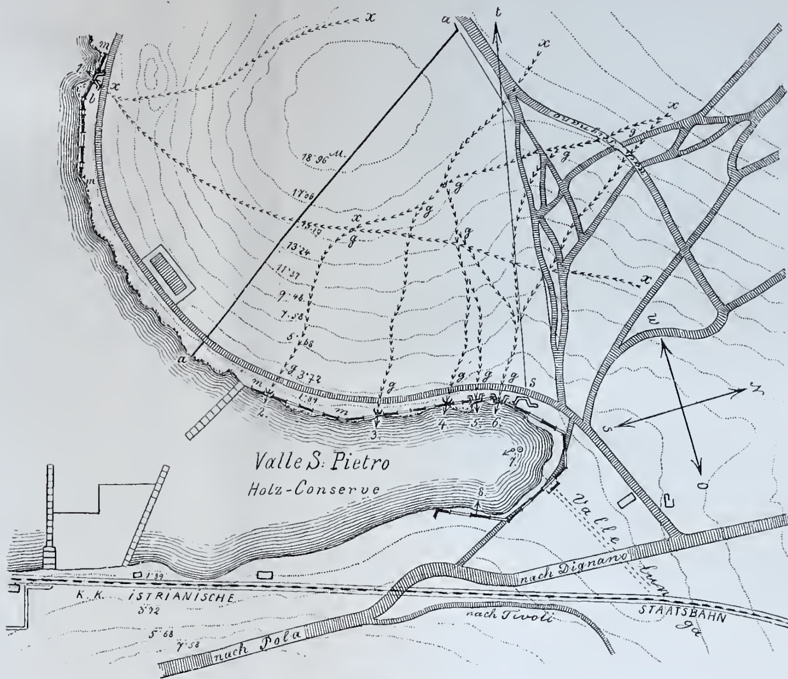
1 bis 6) Haupt-Austrittsstellen des unterirdischen Wasserlaufes der nordsüdlichen Mittelgefälls- und Niederschlagszone. 7 und 8) Austrittspunkte von unterirdischen Abflüssen des Muldengebietes von Valle lunga. a) Grenzmauer des Marine-Artillerie-Territoriums. x-x) Wahrscheinliche und mögliche Richtlinien des unterirdischen Hauptgerinnes und g-g) seiner Abzweigungen nach der Mündungs-Region. s-t) Richtlinie des projectirten Untersuchungs-Stollens. m) Abschlussmauer-Strecken gegen das Eindringen des Meerwassers. b) (1-5-6) Hauptpunkte für Anlage der ersten Schutzmauer-Strecken in Verbindung mit Stauungs-Bassins zur Voruntersuchung der Süßwasser-Abflüsse.
