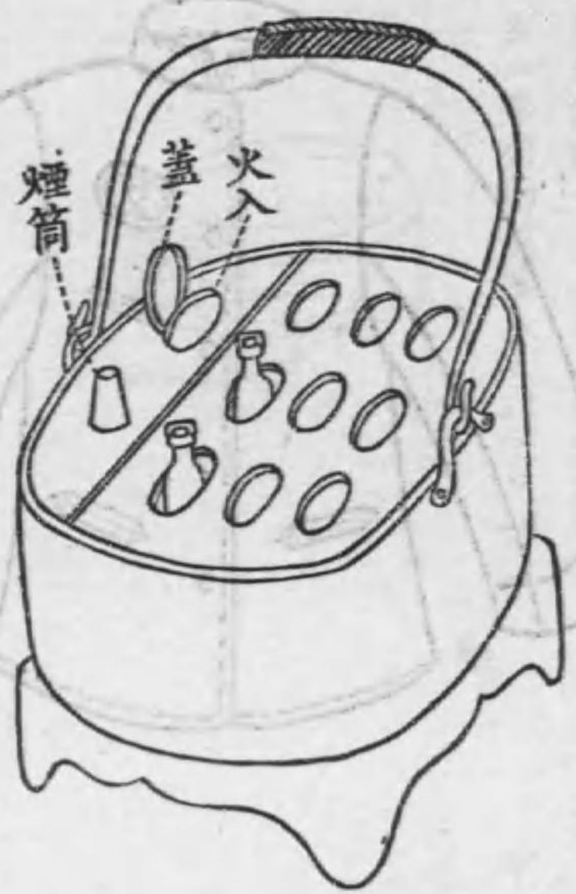
牛乳瓶容器 本器ハ角、楕圓形等ノモノモ使用スルコトヲ得
