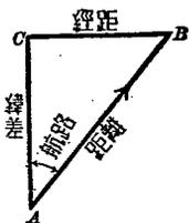
註 如遇  $AB$  過長,則結果不能準確合用.這時應分距離  $AB$  為若干部份(如上頁圖中的  $AE, EG, GI, IB$  等),使各部分甚小,可用差近略值為止.
