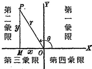
註 這二垂直線叫坐標軸,或位標軸,橫的為  $OX$  軸,縱的為  $OY$  軸,交點(即角的頂點)叫原點.
