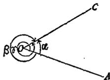
例 上圖中:  $\angle\alpha=30^\circ$ ,  $\angle\beta=-330^\circ$ ,  $\angle\gamma=390^\circ$ , 其始終兩邊位置均同.
