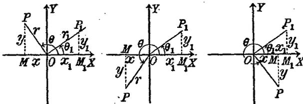
如上圖，取  $OP_1 = OP$ ，則  $rt. \triangle OMP \equiv rt. \triangle OM_1P_1$ ，故  $x, y, r$  三量絕對值和  $y_1, x_1, r_1$  三量各別相同由此便知  $90^\circ + \theta, 270^\circ - \theta, 270^\circ + \theta$  的函數與  $\theta$  的餘函數，二者有相等絕對值再按角所在的象限定函數值的符號即可證明上節各公式。
