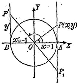
由此可知  $\theta$  角的值由  $0^\circ$  起漸增，則  $P$  點向上移動，所以  $\overline{AP}$  的值，也漸次增大。如  $\theta = 90^\circ$ ，則其終邊與在  $A$  點切線平行，而不相交。在這時  $\tan \theta$  的值不能確定。但是如取  $\theta$  值與  $90^\circ$  相近，則可使  $\tan \theta$  的值，大於任何大的數。這種情形，可用符號  $\tan 90^\circ \rightarrow \infty$  來表示。這個算式，其實就是說“ $90^\circ$  的角，正切值不能確定，但如取  $\theta$  值與  $90^\circ$  非常接近，則可使  $\tan \theta$  的值大到任何程度。”
