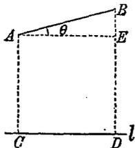
面上的二垂線,  $C$  與  $D$  為垂線與平面交點, 則  $CD$  叫做  $AB$  在這平面上的射影,  $AB$  與這射影所成角, 叫做  $AB$  與這平面的交角.
