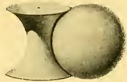
Abb. 13. Ein aus Rolle und Kugel bestehendes Berührungspaar. Die Achse der Rolle ist bei aufrechterhaltenem Schluß relativ zur Kugel flächenläufig.
