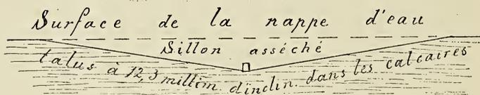
Il existe le long d'une galerie semblable un sillon asséché qui représente dans la nappe une dépression dont les talus ont leurs pieds tournés vers la galerie même et se profilent suivant des angles d'inclinaison en rapport avec le degré de perméabilité du sol. C'est ce fait que nous avons exposé au début en faisant connaître la manière d'être des eaux souterraines.
