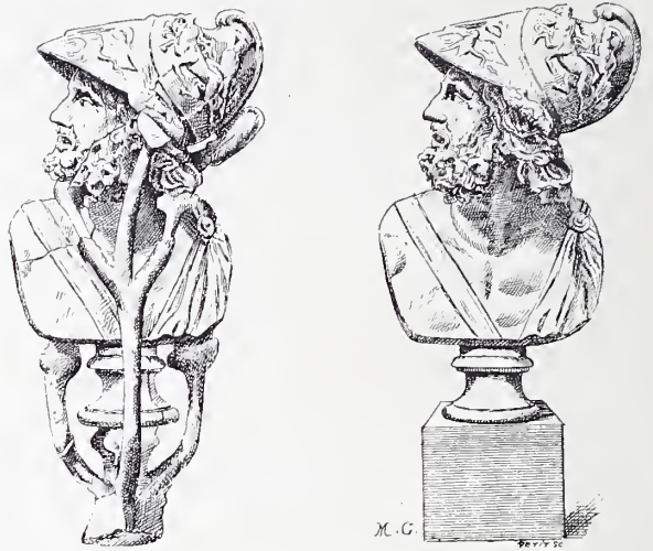
Fig. 648 et 649. — Fonte. — Le buste d'Ajax au sortir de la fonte. Le même, après son achèvement.
