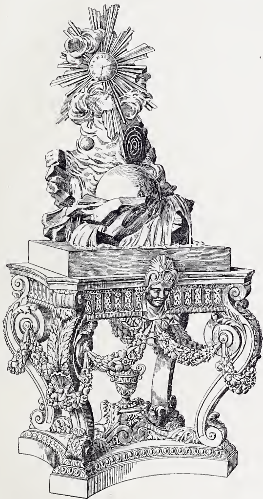
Fig. 925. — Horloge astronomique, dite de la Création du monde, construite par Passemont. — Palais de Versailles.
