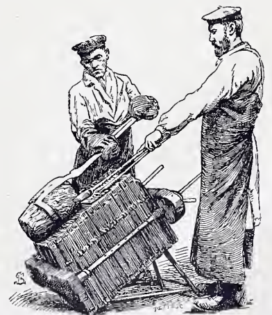
Fig. 628. — Fondeurs versant le métal en fusion dans la chape.
