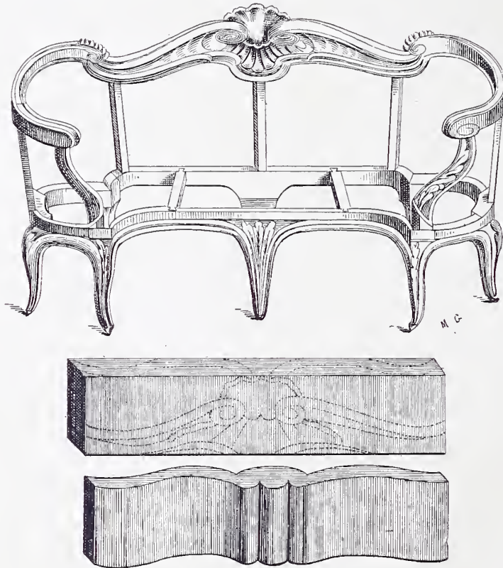
Fig. 29 à 31. — Débillardement d'un dossier de canapé.
