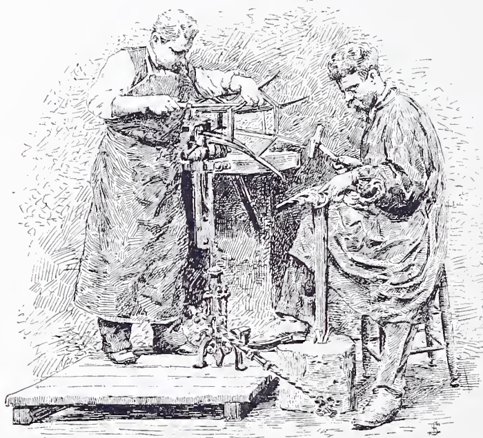
Fig. 535. — Travail du fer. Serrurier relevant à froid des ornements de tôle.
