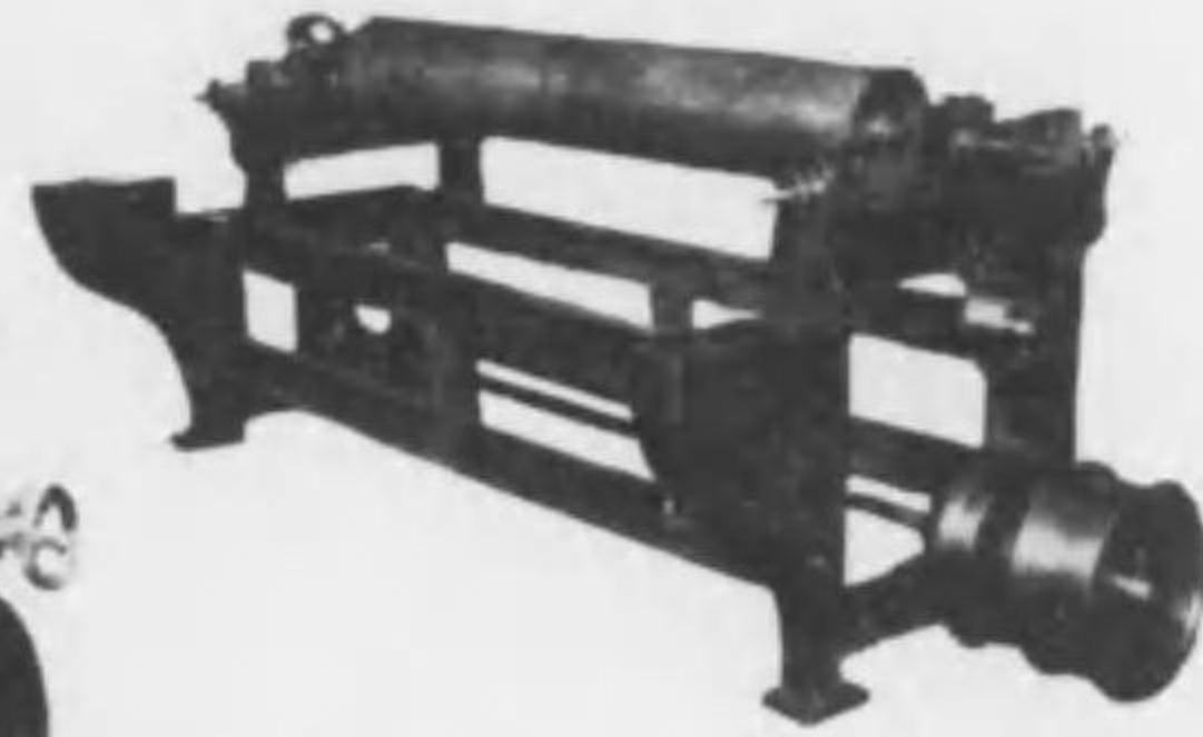
ロール研磨機 (70吋, 60吋, 50吋, 40吋家用)
