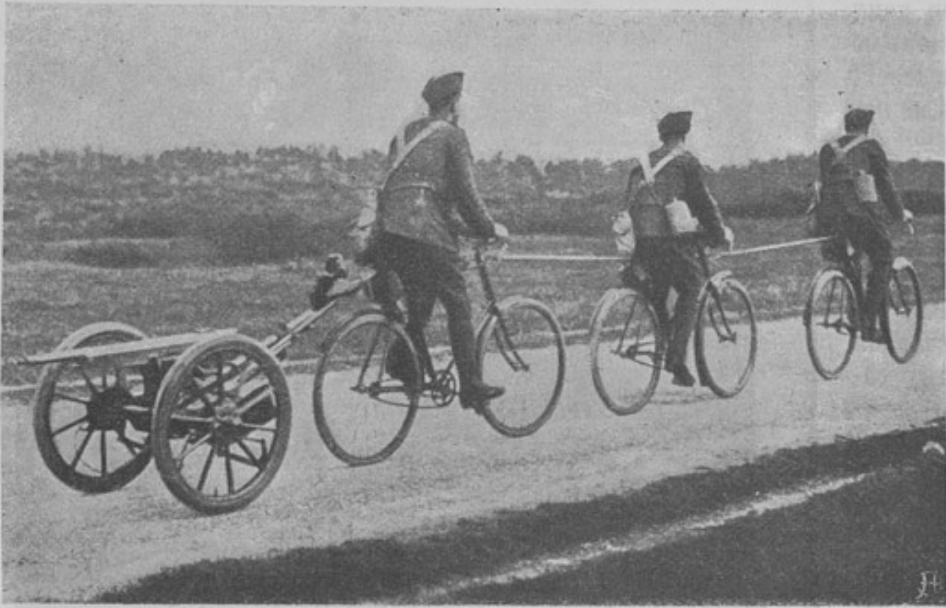
Маневры въ Англии. Пѣхотный пулеметъ, приспособленный для перевозки при помощи велосипедистовъ.
