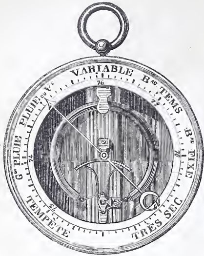
Baromètre de poche de Bourdon.
