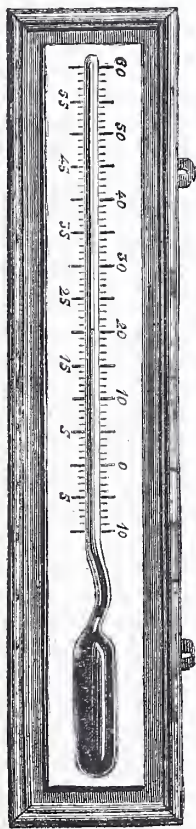
Thermomètre à maxima de Negretti et Zambra.
