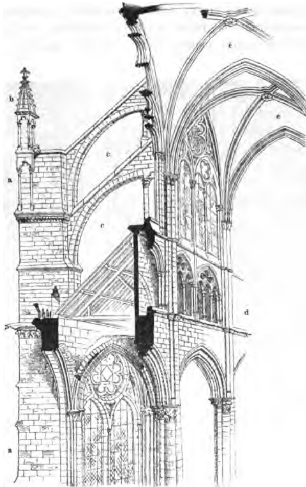
Рис. 46. Система готической постройки (Амьенск. соборъ). а. Опорные столбы, б. Флажъ, с. Провислая арка, д. Трифорій, е. Крестовый сводъ.
