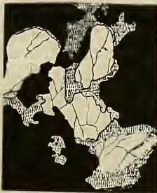
Fig. 2. Gediegenes Eisen, randlich von Magnetit und Magnetkies umwachsen. Vergr. 120.
