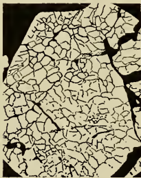
Fig. 6. Körniger Magnetkies vom Versuch III, rekristallisiert. Vergr. 49.
