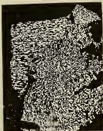
Fig. 2. Magnetkies-Pseudomorphose nach Pyrit, in Würfelform. Versuch 1. Vergr. 48.
