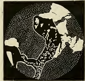
Fig. 1. Reliktstruktur von Magnetkies in schlackigem Magnetit (links unten auch etwas gediegenes Eisen). Vergr. 500.
