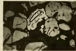
Fig. 3. Ilmenitkristall in körnigem Magnetiteinschluß. Vergr. 232.
