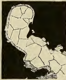
Fig. 3. Gediegenes Eisen mit randlichem Saum von Magnetit, in Magnetkiesknolle eingeschlossen. Vergr. 134.
