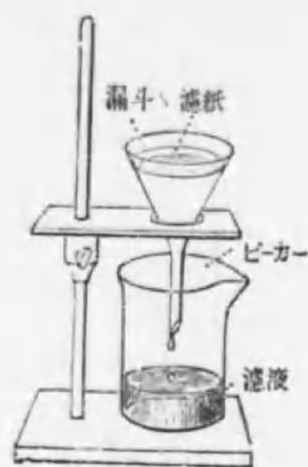
【水の濾過装置】
