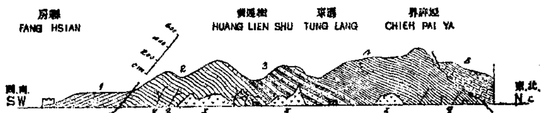
第一圖 1. 第三紀紅砂岩; 2—4 武當片岩, 2 灰黃及灰綠砂質片岩夾石英砂質片岩, 3 灰黃及暗棕色石英片岩間夾細軟片岩, 4 灰黃及灰綠片岩帶夾砂質, 5 震旦片岩. q 石英侵入脈. I 基性侵入岩.
