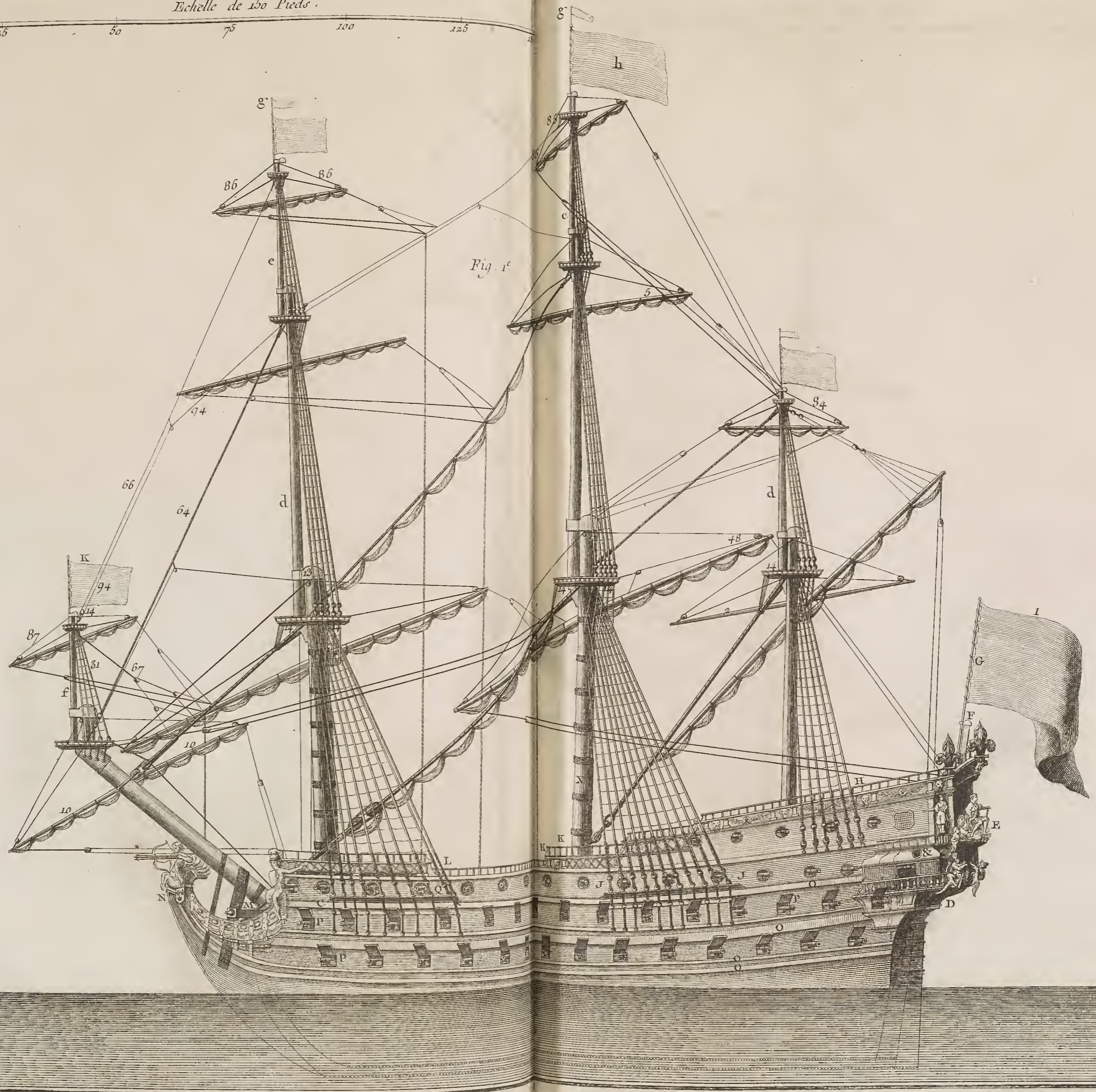
Marine, Vaisseau du Premier Rang avec ses Mâts, Vergues, et quelques uns des principaux Cordages.
