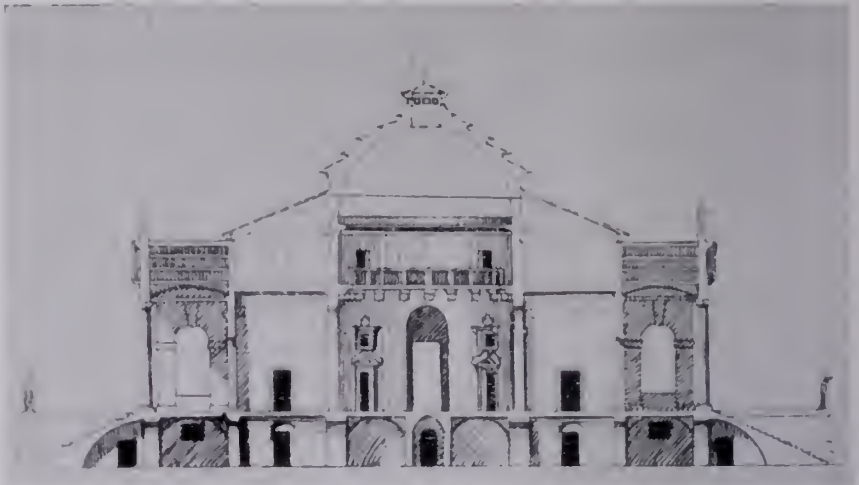
Fig. 338 — Vicenza (dintorni), Villa detta la Rotonda. Palladio; Sezione della Villa, dal disegno di Fritz Burger. (Dal libro: Die Villen des Andrea Palladio).
